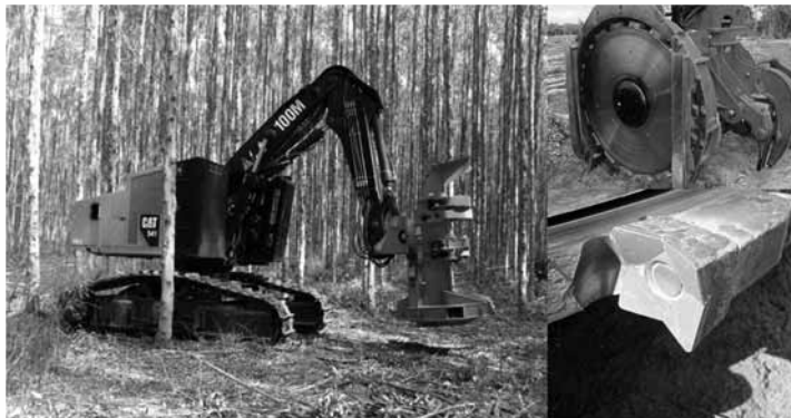
Figura 1. Equipamento Feller Buncher e detalhe da ferramenta de corte disco com vídias.
